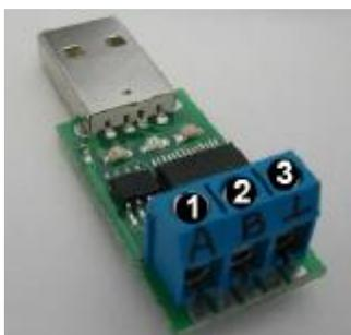
Устройство сопряжения USB-RS485 служит для подключения аппаратов с интерфейсом 485 к USB порту компьютеров. Оно использует стандартные драйверы FTDI с использованием виртуального COM-порта. При подключении адаптера в порт USB будет обнаружено новое устройство. Драйверы для него находятся здесь: [http:// ftdichip.com/Drivers/](http://ftdichip.com/Drivers/)
