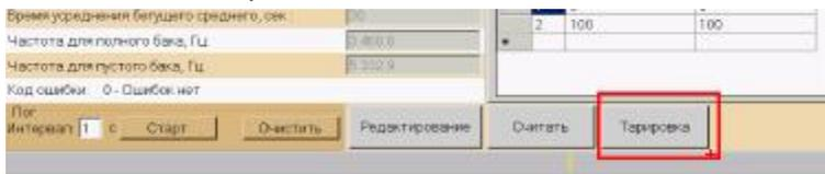
4. Ожидаем момент, когда в ячейке МГНОВЕННАЯ ЧАСТОТА показания топлива станут неизменными (1). Нажимаем кнопку ПОЛНЫЙ БАК (2). При этом показания занесутся в строку ЧАСТОТА ДЛЯ ПОЛНОГО БАКА.
